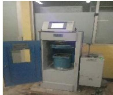
**Gambar 6.** Mesin pengukur kuat tekan
