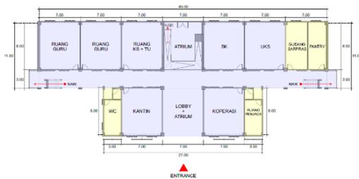
**Gambar 4. Blok Denah Rancangan Gedung SMP Kanisius Kalasan.**
