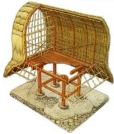
Gambar 4. Bentuk rangka penyangga dan lempengan atap Lombok yang melengkung Sumber: Fitanisya, 2015
