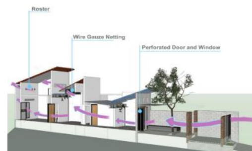
Gambar 6. Pintu, jendela dan wire gauze netting di area dapur
